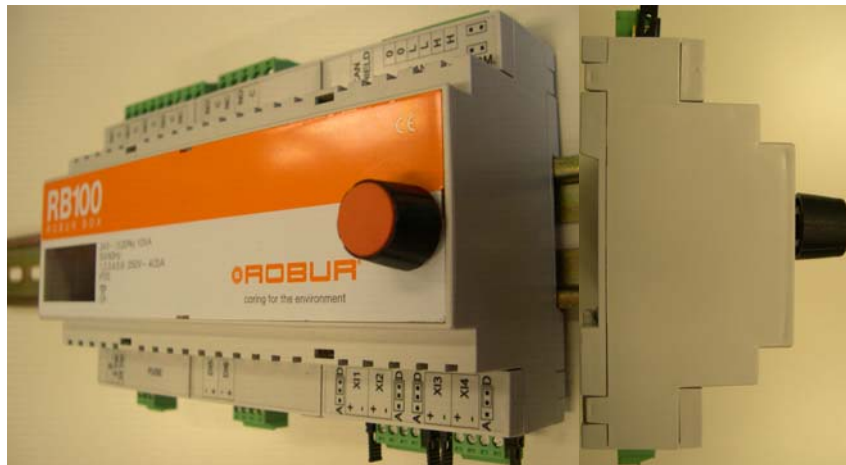
Figure 3 Appliance installation on DIN guide (EN 60715)
